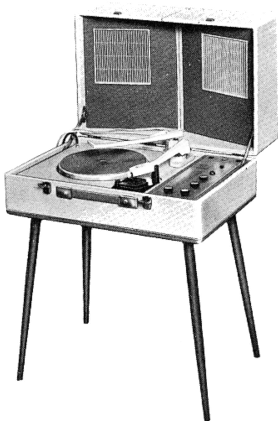
**FONOVALLIGIA** stereo-mono trasformabile in console. Cambiadischi automatico « Garrard » a 4 velocità. Controllo volume, regolazione toni alti e bassi. Potenza d'uscita 6 W indistorti (3 W per canale). Alimentazione universale 110 ÷ 220 V. Mobile in legno ricoperto in vinilpelle. Altoparlanti staccabili dal coperchio. Ottima fedeltà di riproduzione.
